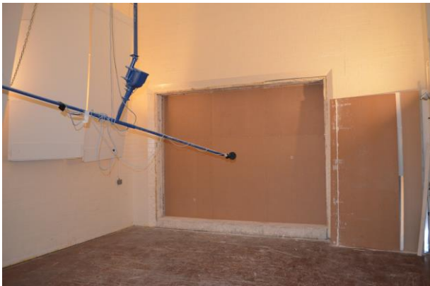
Figure 2: Reverberation room measurements (EN 1793-1)
